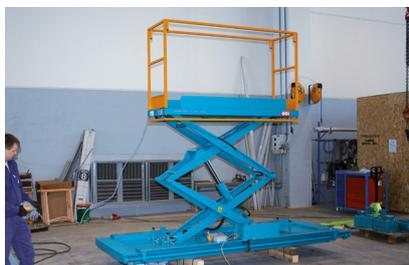
Sviluppata per le macchine di grandi dimensioni, la piattaforma idraulica scorrevole consente di effettuare in modo rapido e sicuro l'ispezione degli elementi filtranti e la manutenzione ordinaria della macchina.
