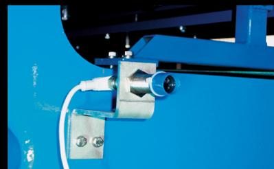
Controlla il regolare allineamento del pacco piastre e arresta il filtro in caso di anomalie, prevenendo così l'insorgere di danni.
