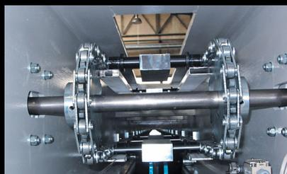
Assicura, mediante un sistema automatico di trasmissione a catena controllato da inverter, un rapido e sequenziale spostamento delle piastre. Il sistema antisgancio integrato impedisce il prematuro rilascio delle piastre.
