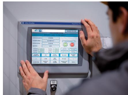
I GHS sono dotati di un sofisticato sistema di automazione dotato di interfaccia uomo-macchina (HMI) che facilita il monitoraggio del funzionamento del filtro, la diagnostica guasti e consente l'adeguamento continuo dei parametri di filtrazione al fine di ottimizzare le richieste variabili del processo.
