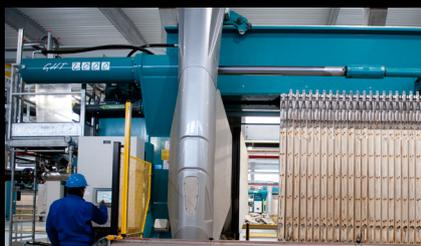
Garantisce, mediante un braccio meccanico robotizzato munito di spazzole e ugelli, un'efficace roigenerazione delle tele e, quindi, un costante rendimento di filtrazione nel tempo.
