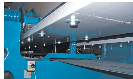
Il meccanismo di distaffaggio, ubicato all'interno della trave superiore è adeguatamente isolato mediante un nastro continuo in tela gommata, per una protezione totale da fango, polvere e aggressioni chimiche.
