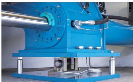
Le celle di carico, poste sotto i piedi di appoggio, monitorano costantemente il peso della macchina per assicurare che tutti i pannelli vengano scaricati e controllano la qualità di prodotto pompato all'interno della stessa.
