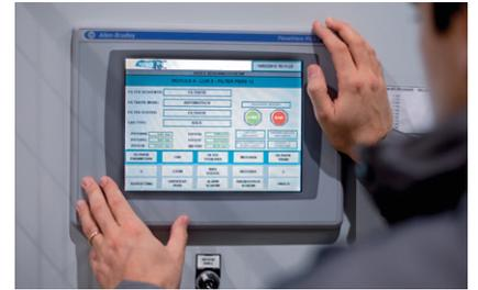
Los GHS están equipados con un sistema de automatización avanzado con interfaz operador – máquina (HMI), lo que hace mucho más sencillo el control del funcionamiento del filtro, el diagnóstico de eventuales fallas y además el control continuo de los parámetros de filtración con el fin de optimizarlos según las variables de proceso.
