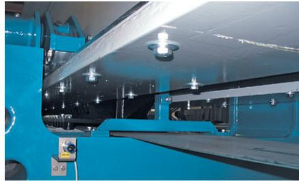
El mecanismo de deslizamiento, situado en el interior de la viga superior, está totalmente aislado de lodo, polvo y agresiones químicas por medio de una cinta continua en tela engomada.
