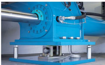
Las celdas de carga, ubicadas debajo de las piernas de apoyo, monitorea constantemente el peso del equipo para asegurar que todas las tortas se descarguen regularmente. También permiten controlar la cantidad de producto alimentado al filtro prensa.
