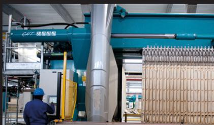
Garantiza la limpieza eficaz de las telas por medio de un brazo mecánico robotizado y por lo tanto, un rendimiento de filtración constante en el tiempo.
