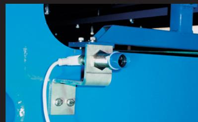
Controla la alineación regular del paquete de placas y del filtro prensa en caso de anomalías, evitando posibles averías.
