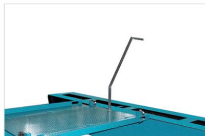
Pasarela deslizante, colocada debajo del paquete de placas para la inspección y el reemplazo de las telas.
