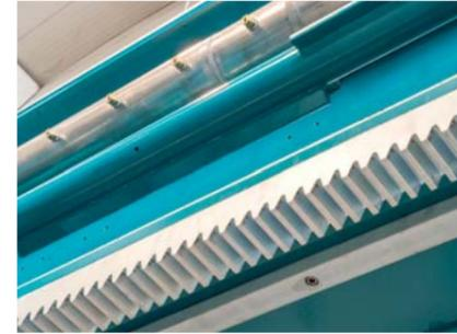
El sistema de sacudimiento automático de placas, programado tras cada ciclo, garantiza la descarga perfecta de la torta y/o de posibles residuos superficiales que las telas puedan tener, además de asegurar el automatismo total de la máquina.
