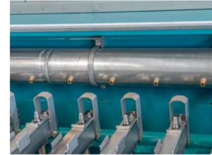
El lavado de telas por enjuague, efectuado tras cada ciclo, permite una limpieza óptima tanto por arriba como debajo de las telas filtrantes evitando que se acumulen los residuos de torta o de polvo. La posición de las barras de lavado en ambos lados de las vigas superiores y en correspondencia de la base de las placas garantiza el lavado perfecto de todo el tejido filtrante dejando libre la zona superior de la máquina para las operaciones de mantenimiento ordinario.
