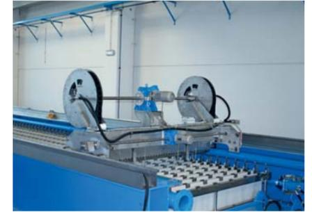
El lavado a alta presión, programable según las exigencias, permite una regeneración eficaz de la permeabilidad del tejido filtrante y por lo tanto una duración mayor de las telas, manteniendo un rendimiento constante del proceso de filtración en el tiempo.
