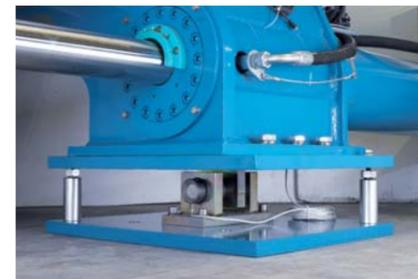
Las celdas de carga, ubicadas debajo los puntos de anclaje, monitorean constantemente el peso de la máquina para asegurar que todas las tortas se descarguen regularmente. También permiten controlar la cantidad de producto alimentado al filtro prensa.
