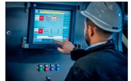
Los GHT F están equipados con un sistema de automatización avanzado con interfaz operador-máquina (HMI) que facilita el control del funcionamiento del filtro, el diagnóstico de eventuales fallas y permite adaptar continuamente los parámetros de filtración con el fin de optimizarlos según las variables del proceso.
