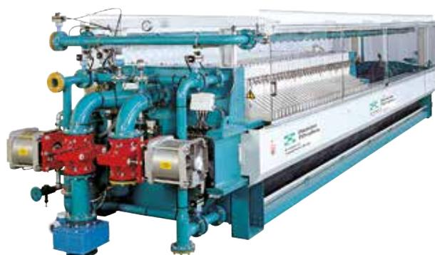
Il filtro pressa Diemme® Filtration ME è un filtro a trave laterale estremamente versatile. Grazie al sistema di apertura simultaneo del pacco piastre, la fase di scarico pannelli è estremamente rapida. Per questa ragione è particolarmente adatto ai prodotti ad alta filtrabilità ed elevata velocità di filtrazione.
