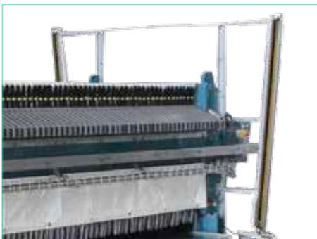
Чтобы максимально повысить удобство осмотра и обслуживания оборудования и обеспечить простоту работы для операторов и обслуживающего персонала, мы разработали меры безопасности, состоящие из фиксированных барьеров на концевых плитах и световых отражателей, которые обеспечивают оператору доступ сбоку к фильтр-пакету без остановки машины.
