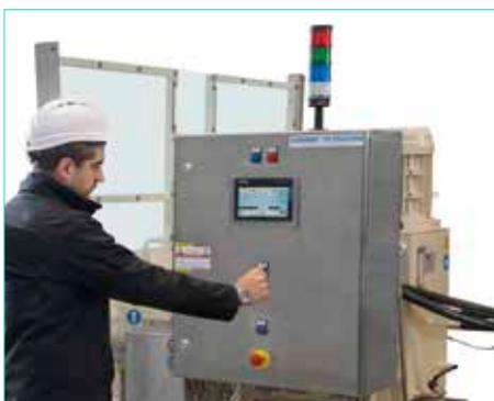
Фильтр-прессы серии «АУТОМАТ» оснащаются современной системой автоматизации с интерфейсом оператор-машина (HMI), которая позволяет оператору регулировать различные параметры фильтрации, оптимизируя производственный процесс. Интерфейс (HMI) отражает работу фильтра и вспомогательных систем, осуществляет диагностику с фиксацией технологических параметров.
