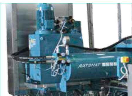
Обладает высокой надежностью, обеспечивается гидроцилиндром, который перемещает напорную плиту для зажима пакета фильтровальных плит на стадии фильтрации, или открытия фильтра для выгрузки кека, или промывки фильтра.
