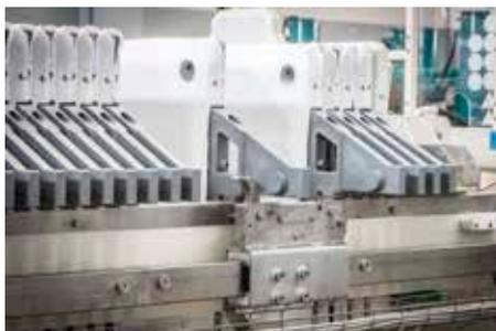
Механизм перемещения плит с электроприводом, двойные крюки, тяговые цепи расположены во внутренних частях боковых балок. На стадии открытия фильтра и выгрузки кека фильтровальные плиты перемещаются крюками по одной. Электродвигатель, обеспечивающий перемещение, оснащен частотным преобразователем. Скорость перемещения плит регулируется с электрошита управления.
