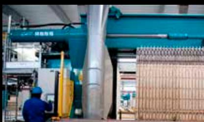
Исключительно тщательная очистка фильтровальных тканей с использованием роботизированного моечного устройства гарантирует поддержание оптимальной скорости фильтрации и увеличивает срок службы фильтровальных тканей.
