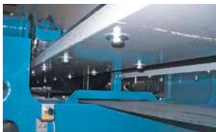
Механизм перемещения пластин смонтирован внутри верхней траверсы, эффективно защищен от попадания шлама, пыли и агрессивных химических веществ сплошной лентой из прорезиненной ткани.
