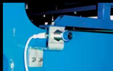
Лазерная система управления контролирует геометрические размеры пакета пластин и останавливает фильтр-пресс в случае любых отклонений от нормы, что позволяет избежать каких-либо повреждений.
