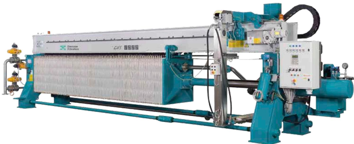
**Перемещение пластин цепным механизмом карусельного типа**
