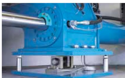
Динамометрические датчики, установленные под опорами фильтра, непрерывно контролируют вес оборудования, включая вес получаемого кека и количество отфильтрованной пульпы.
