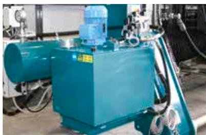
Мощная гидравлическая система закрытия пакета фильтровальных пластин обеспечивает высокую надежность и стабильность работы в любых условиях.
