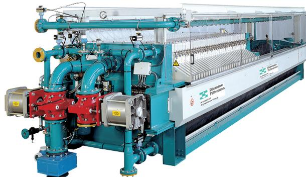
Фильтр-пресс Diemme® Filtration модели ME представляет собой чрезвычайно универсальный фильтр-пресс с боковыми балками. Благодаря системе одновременного открытия фильтровального пакета пластин, разгрузка чека происходит очень быстро. По этой причине эта машина подходит для продуктов с высокой фильтрующей способностью и высокой скоростью фильтрации.
