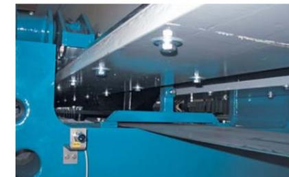
Le mécanisme de débâtissage, placé à l'intérieur de la poutre supérieure, est isolé d'une manière adéquate de tout contact avec le produit, les eaux de lavage et les agressions chimiques, garantissant sa très longue longévité.
