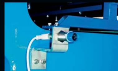
Il contrôle que l'alignement du paquet-plateaux est régulier et arrête le filtre-presses en cas d'anomalies de positionnement, afin d'éviter toutes détériorations.
