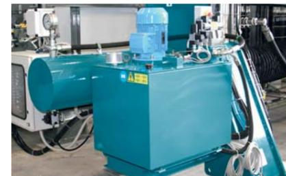
La centrale hydraulique assure automatiquement la fermeture du paquet-plateaux ainsi que le maintien de la pression pendant toute la durée de la filtration. L'utilisation de composants de grandes marques assurent sa très haute fiabilité pour des coûts de maintenance réduits.
