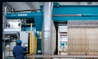
Grâce à son bras mécanique équipé de buses de lavage à haute pression, le robot garantit un nettoyage efficace des toiles de filtration, garantissant un rendement de filtration constant dans le temps.
