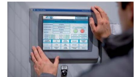
Les GHS sont dotés d'un système d'automatisation sophistiqué via une interface homme-machine (HMI) qui facilite la supervision du fonctionnement du filtre, le diagnostic des pannes et permet l'adaptation continue des paramètres de filtration aux requêtes du process à fin de l'optimiser.
