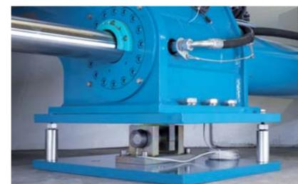
Les pesons, placés sous les pieds du filtre, contrôlent le poids de la machine garantissant que tous les gâteaux soient déchargés à la fin de chaque cycle et assurant un suivi journalier de la production.
