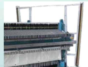
Para optimizar la accesibilidad y la simplicidad de utilización de la máquina por parte del operador, se han proyectado protecciones de seguridad con elementos fijados en los cabezales y protecciones con cortina fotoeléctrica que permiten un posible acceso lateral al paquete de placas sin que la máquina se pare.
