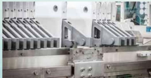
El deslizamiento de las placas, que permite la descarga de la torta, se realiza con 2 carros completos de mangos automáticos que enganchan las placas una por una. Los carros están accionados por correas dentadas insertadas al interior del sistema de guía de los mismos carros. Se trata de un sistema muy flexible que se puede adaptar a los diferentes espesores de placas.
