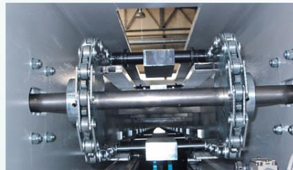
Permite el deslizamiento rápido y secuencial de las placas por medio de un dispositivo automático de transmisión por cadena controlado por un convertidor de frecuencia.
