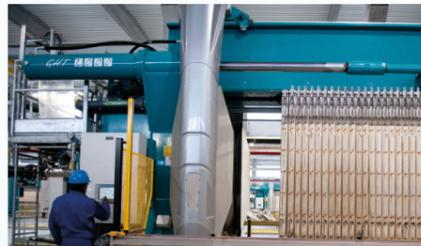
Garantiza la limpieza eficaz de las telas por medio de un brazo mecánico robotizado y por lo tanto, un rendimiento de filtración constante con el tiempo.
