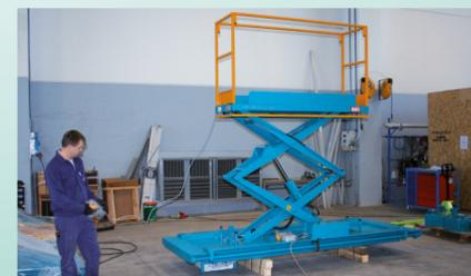
Este dispositivo ha sido diseñado para equipos de grandes dimensiones, la plataforma hidráulica deslizante permite inspeccionar de forma rápida y segura el estado de los elementos filtrantes, así como efectuar operaciones de mantenimiento ordinario del equipo..
