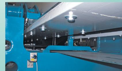
El traslado de las placas, ubicado dentro de la viga superior, está aislado de manera adecuada por medio de una banda continua de tejido engomado para una protección total de lodo, polvo y agresiones químicas.
