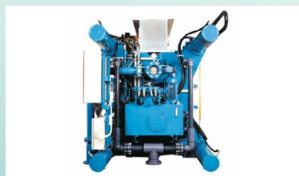
Realizado de acero con estructura de "nido de abeja" para una óptima resistencia a los esfuerzos, sostiene los cuatro pistones hidráulicos responsables del cierre del paquete de placas.
