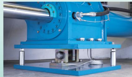
Las celdas de carga, ubicadas debajo de las piernas de apoyo, monitorea constantemente el peso del equipo para asegurar que todas las tortas se descarguen regularmente. También permiten controlar la cantidad de producto alimentado al filtro prensa.
