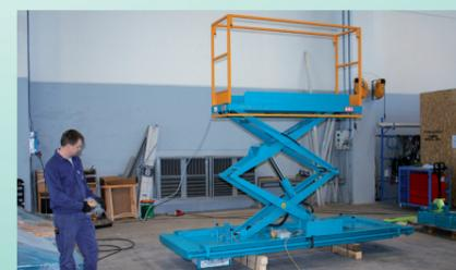
Sviluppata per le macchine di grandi dimensioni, la piattaforma idraulica scorrevole consente di effettuare in modo rapido e sicuro l'ispezione degli elementi filtranti e la manutenzione ordinaria della macchina.
