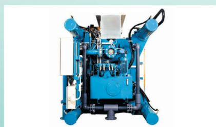
Realizzata in acciaio alto-resistenziale, con struttura "a nido d'ape", è in grado di minimizzare le sollecitazioni e di sostenere i quattro martinetti idraulici responsabili del serraggio del pacco piastre.
