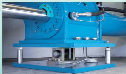
Le celle di carico, poste sotto i piedi di appoggio, monitorano costantemente il peso della macchina per assicurare che tutti i pannelli vengano scaricati e controllano la qualità di prodotto pompato all'interno della stessa.
