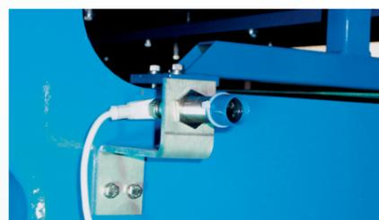
Controlla il regolare allineamento del pacco piastre e arresta il filtro in caso di anomalie, prevenendo così l'insorgere di danni.
