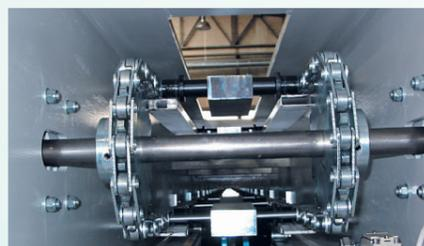
Assicura, mediante un sistema automatico di trasmissione a catena controllato da inverter, un rapido e sequenziale spostamento delle piastre. Il sistema antisgancio integrato impedisce il prematuro rilascio delle piastre.
