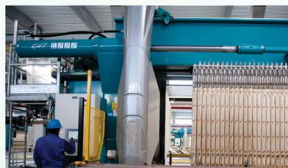
Garantisce, mediante un braccio meccanico robotizzato munito di spazzole e ugelli, un'efficace rigenerazione delle tele e, quindi, un costante rendimento di filtrazione nel tempo.
