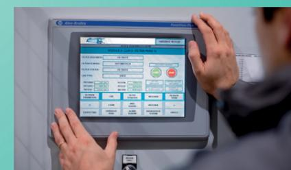
I GHT sono dotati di un sofisticato sistema di automazione dotato di interfaccia uomo-macchina (HMI) che facilita il monitoraggio del funzionamento del filtro, la diagnostica guasti e consente l'adeguamento continuo dei parametri di filtrazione al fine di ottimizzare le richieste variabili del processo.
