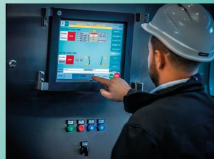
I GHT-F presentano un sofisticato sistema di automazione dotato di interfaccia uomo-macchina (HMI) che facilita il monitoraggio del funzionamento del filtro, la diagnostica guasti e consente l'adeguamento continuo dei parametri di filtrazione al fine di ottimizzare le richieste variabili del processo.
