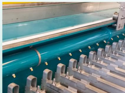
Il lavaggio a pioggia, effettuato dopo ogni ciclo, permette una pulizia ottimale sia dall'alto che dal basso delle tele filtranti evitando l'accumulo di residui di pannello o di polvere. La dislocazione delle barre di lavaggio, ai lati delle due travi superiori e in corrispondenza della base delle piastre, garantisce la perfetta irrorazione di tutto il tessuto filtrante lasciando libera la zona superiore della macchina per le operazioni di manutenzione ordinaria.
