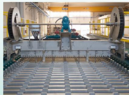
Il lavaggio ad alta pressione, programmabile secondo esigenze, fornisce un'efficace rigenerazione della permeabilità del tessuto filtrante e quindi una maggior vita delle tele, mantenendo un costante rendimento del processo di filtrazione nel tempo.
