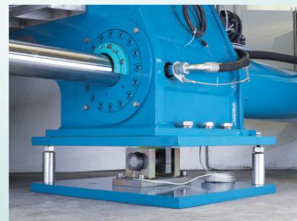
Le celle di carico, poste sotto i piedi di appoggio, monitorano costantemente il peso della macchina per assicurare che tutti i pannelli vengano scaricati e controllano la quantità di prodotto alimentato all'interno della stessa.
