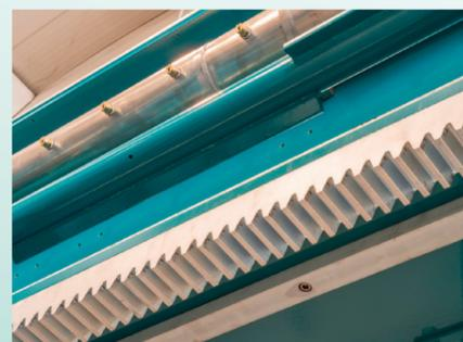
O sistema de vibração automático das placas, programado para ocorrer após cada ciclo, assegura a descarga perfeita das tortas e evita possíveis resíduos superficiais nas telas de filtração, garantindo assim o total automatismo do filtro prensa
