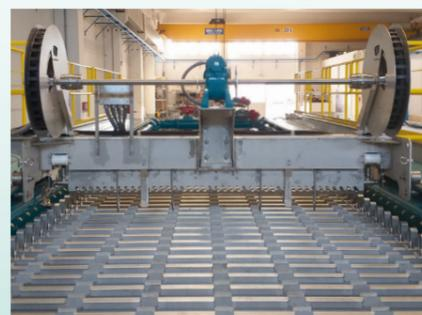
A lavagem de alta pressão programável conforme a necessidade de cada processo, permite a regeneração eficaz da permeabilidade das telas de filtração, o que proporciona uma maior vida útil das telas e permite que o rendimento constante da filtração seja mantido ao longo do tempo.
