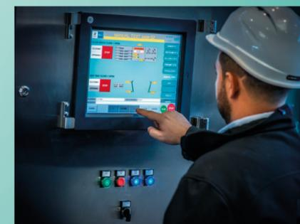
Os filtros prensa GHT F estão equipados com um avançado sistema de automatização através da IHM – Interface Homem Máquina que facilita o controle do funcionamento e operação do filtro prensa, com diagnóstico de eventuais falhas, permitindo a adequação contínua dos parâmetros de filtração com o objetivo de otimizar as variáveis de processo.
