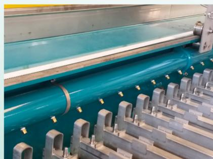
A lavagem das telas de filtração por enxague é realizada após cada ciclo, permite uma ótima limpeza tanto na parte frontal como também atrás das telas, evitando que se acumulem resíduos de tortas e poeira. A posição bilateral das barras de lavagem nas vigas superiores em relação a base das placas, garantem uma limpeza completa de toda a área das telas de filtração, deixando a parte superior do filtro prensa totalmente livre para acesso da manutenção de rotina.
