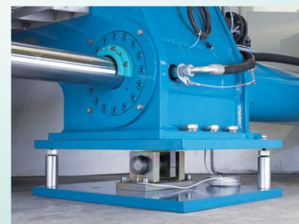
As células de carga, montadas na base das cabeceiras de fixação do filtro prensa, monitoram de forma contínua o peso do filtro para garantir que todas as tortas sejam descarregadas regularmente. Adicionalmente permite controlar a quantidade de produto alimentado ao filtro prensa em cada ciclo.
